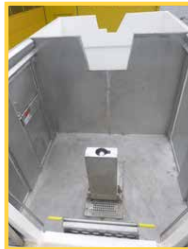
Lavage de l'intérieur du conteneur par roto-buse escamotable
